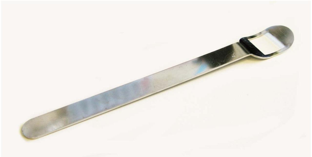
Abb. 1 Sterilisierbare Edeltstahlschablone zur standardisierten Probenahme
